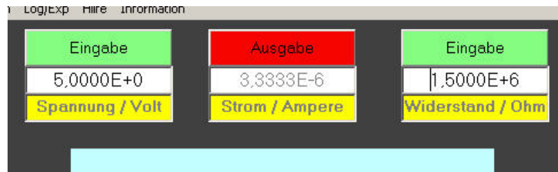
Bild 2. Durch Anklicken des grünen Feldes >Eingabe< für Strom in Bild 1 wechselt es zu rot und wird dadurch zum >Ausgabe< mit I = U / R . Zu einer Spannung von 5 V und einem Widerstand von 1,5 M \Omega gehört ein Strom von 3,3333 \mu A.
